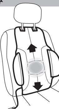
Para regular la altura del respaldo lumbar, colóquese en el asiento. Deslice una mano entre la espalda y el sistema ad'just para soltar el soporte. Deslice su mano y el soporte hacia su zona lumbar y una vez en su sitio, simplemente retire la mano.
